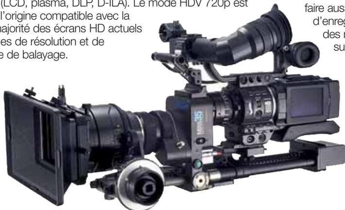
Le modèle GY-HD110, doté d'un adaptateur Mini 35 de P & S Technik, se change en caméra de cinéma numérique.
