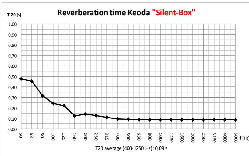
Le silent-Box –XL est fabriqué en mélaminé 18 mm doublé de panneaux isolants 19 mm, et de mousse acoustique 25 mm.
