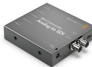
Le Mini Converter Analog to SDI est la solution idéale pour convertir de la vidéo composante analogique, S-Vidéo et composite NTSC/PAL en vidéo SDI. L'audio peut être intégré aux entrées analogiques symétriques ou AES/EBU. Vous pouvez désormais convertir des signaux provenant d'appareils analogiques tels que Betacam SP, VHS, boîtiers décodeurs numériques, consoles de jeux et caméras HDV en vidéo d'excellente qualité SD/HD-SDI.
