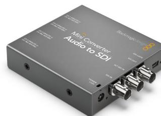
Intégrez l'audio dans des sources SDI aux formats SD et HD, pouvant aller jusqu'à 1080p60 ! Les signaux audio analogique symétrique ou AES/EBU sont envoyés via des connecteurs 1/4" à partir d'appareils, tels que des consoles de mixage et des enregistreurs analogiques. Si vous avez besoin d'un convertisseur qui permet d'intégrer l'audio SD et HD-SDI sans le coût d'un modèle Ultra HD, le Mini Converter Audio to SDI est la solution idéale !
