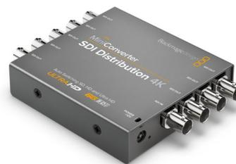
Le Mini Converter SDI Distribution 4K est la solution idéale pour acheminer un signal SDI vers plusieurs appareils SDI. Connectez une seule source SDI à 8 sorties SDI synchronisées qui commuteront automatiquement entre les formats vidéo SD, HD, 3G et 6G-SDI ainsi que tous les formats ASI, auxiliaires et d'audio intégrée.
