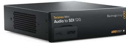
Le Teranex Mini Audio to SDI 12G intègre soit 2 canaux audio analogique symétrique, optique ou RCA HiFi, soit 4 canaux audio numérique AES/EBU à des signaux SDI SD, HD, Ultra HD ou DCI 4K. Intégrez vos signaux audio provenant d'équipements tels que consoles de mixage audio, iPods, et enregistreurs analogiques à des signaux vidéo SDI pour une utilisation avec des grilles de commutation et des enregistreurs SDI.
